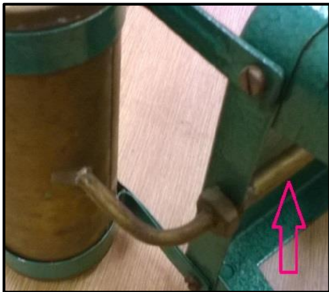
Vaříč Omnia - trubka výparníku obsahující uvnitř tkaninový smotek
